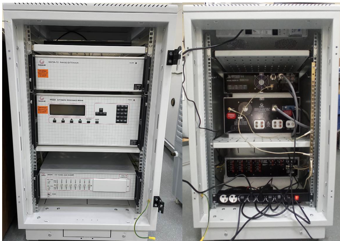
Рисунок 1 - Общий вид лицевой и задней панели установки 6625А с мостом-компаратор 6622А (средний прибор), с расширителем 6623А (верхний прибор), со сканером 6664С (нижний прибор)
