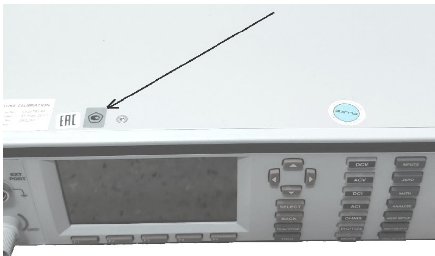
Рисунок 2 – место нанесения наклейки со знаком утверждения типа
