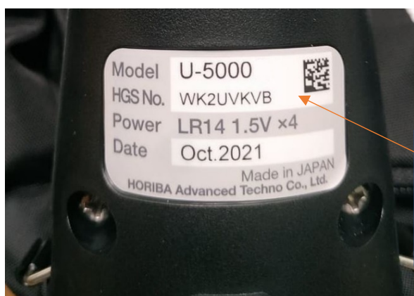
Рисунок 1в - Общий вид задней поверхности вторичного преобразователя (контрольного блока) с указанием места нанесения заводского номера
