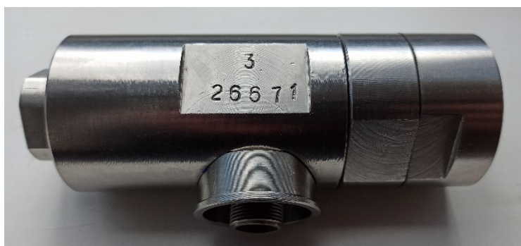
Рисунок 1 – Общий вид преобразователя переменного давления пьезоэлектрического ППД-3
