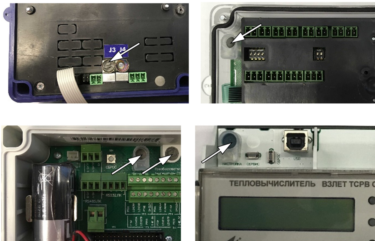
Рисунок 6 – Места пломбировки от несанкционированного доступа
