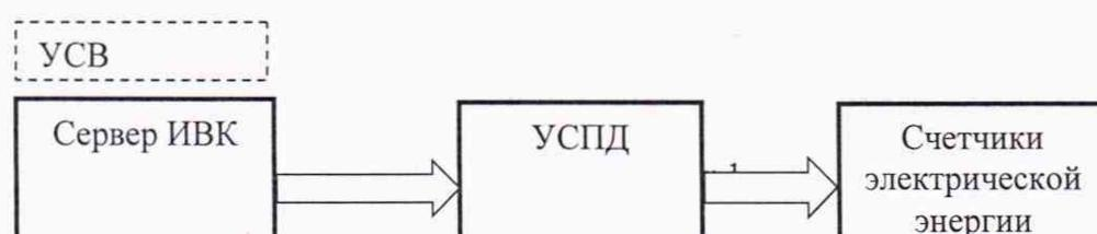
Подключив к серверу ИВК блок коррекции времени ЭНКС-2, определяют пределы смещений шкалы времени сервера ИВК относительно национальной шкалы времени UTC(SU).
