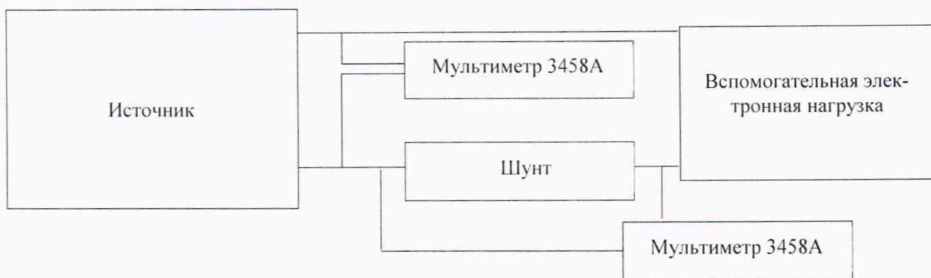
Рисунок 3 - Структурная схема определения нестабильности выходного напряжения постоянного тока, вызванной изменением силы тока в нагрузке, и нестабильности силы выходного тока, вызванной изменением напряжения на нагрузке
