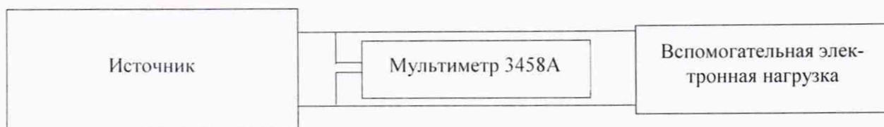
Рисунок 1 – Структурная схема определения абсолютной погрешности воспроизведений/измерений напряжения постоянного тока
