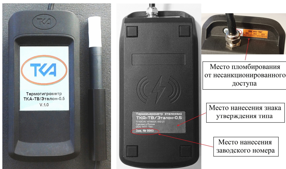
Рисунок 1 - Общий вид термогигрометра эталонного ТКА-ТВ/Эталон с указанием места пломбирования, нанесения знака утверждения типа и заводского номера
