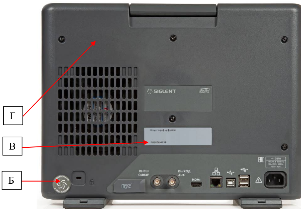
Рисунок 2 – Вид задней панели осциллографов, схема пломбировки от несанкционированного доступа (Б), место нанесения серийного номера (В) и знака поверки (Г).
