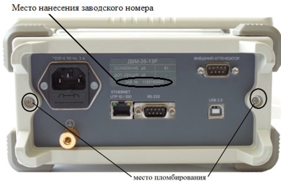
Рисунок 3 - Схема пломбировки от несанкционированного доступа
