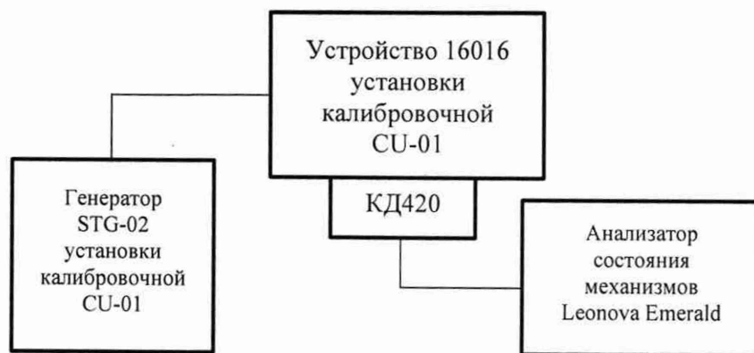
Рис.1. Измерительная схема для проверки диапазона и погрешности измерения ударных импульсов
