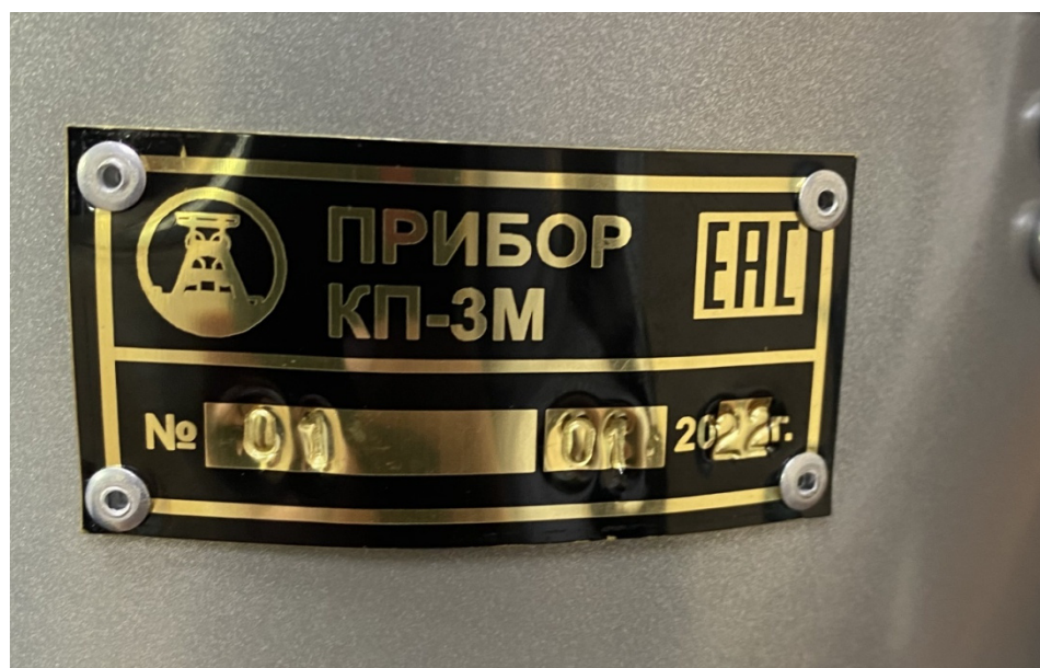
Рисунок 2 – Бирка с указанием наименования прибора, места, способа и формата нанесения заводских номеров, года выпуска и знака производителя
