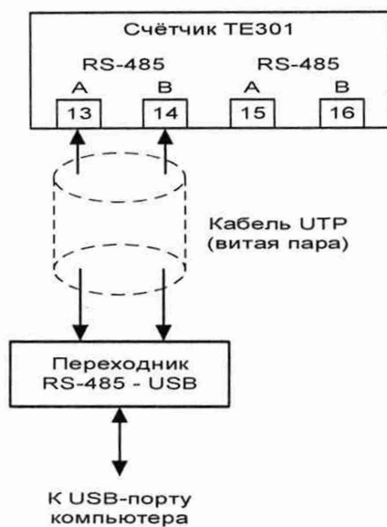
Рисунок Б.3 – Подключение цепей интерфейса RS-485
