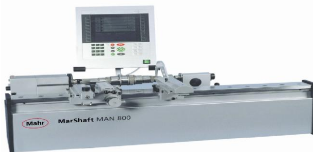
Рисунок 1 – Общий вид системы измерения валов MarShaft MAN
