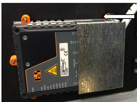
Рисунок 4 – Схема пломбировки от несанкционированного доступа, обозначение места нанесения знака поверки специальной пластины жидкокристаллического экрана установок измерительных «ОЗНА-Агидель» ЖДС-150-0,25
