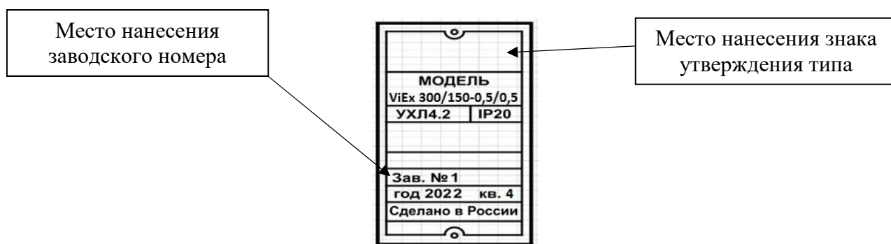
Рисунок 2 – Общий вид маркировочной таблички с обозначением мест нанесения знака утверждения типа и заводского номера
