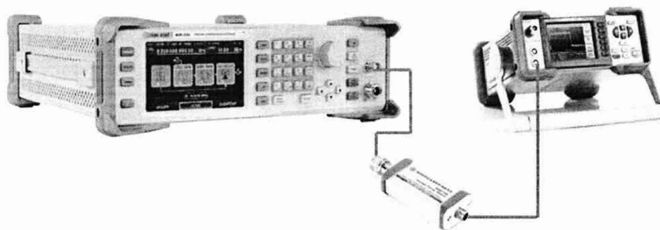
Рисунок 5 – Схема соединения приборов для определения неравномерности АЧХ встроенного НЧ генератора
