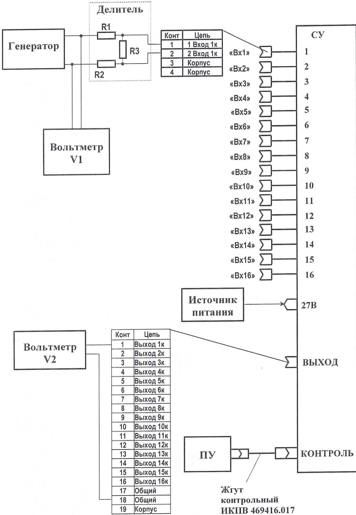
Рисунок Б.2 - Схема соединения для определения коэффициентов усиления и частотных диапазонов
