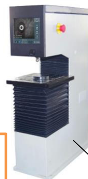
Рисунок 3. Твердомер AutoBrin - 3000AZ
