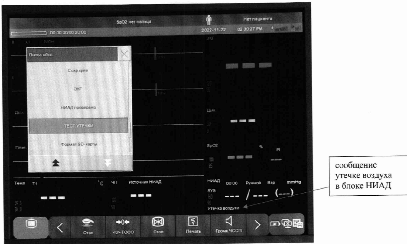
Рисунок 4 – сигнал утечки пневмосистемы монитора.
