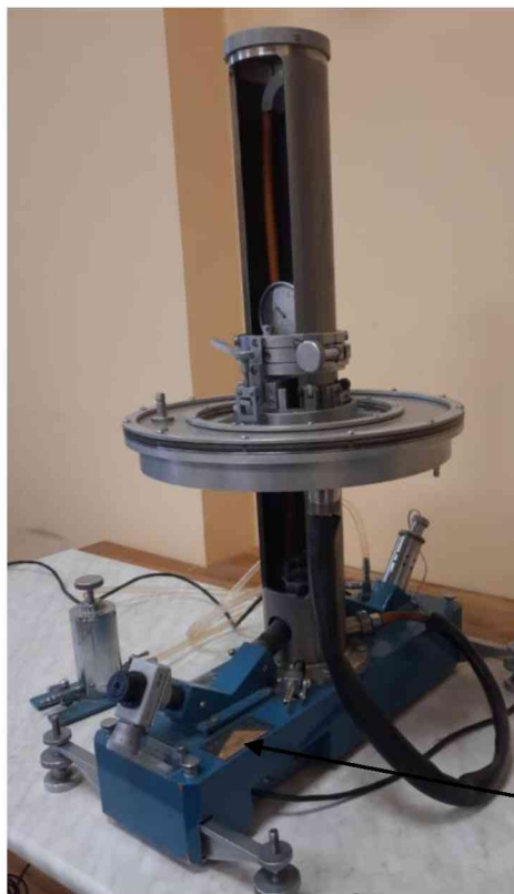
Рисунок 1 – Общий вид микроманометра ПМКМ-1
