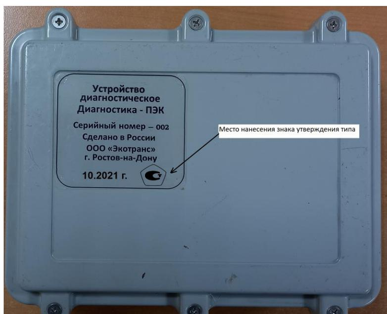
Рисунок 3 – Место нанесения знака утверждения типа и серийного номера
