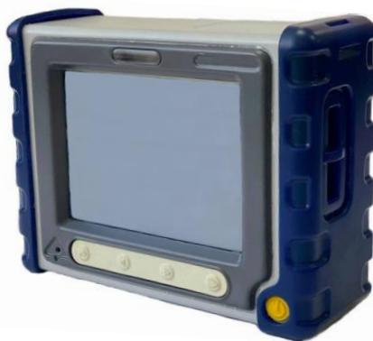
Рисунок 1 – Общий вид газоанализаторов универсальных Эколаб плюс
