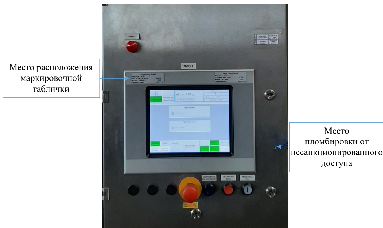
Рисунок 2 – Общий вид системы управления с указанием места расположения маркировочной таблички и места пломбировки от несанкционированного доступа
