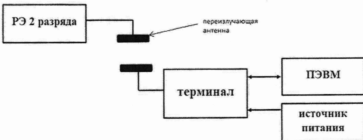
Рисунок 1 – Схема проведения измерений при проверке работоспособности, определения погрешностей измерений координат и скорости
