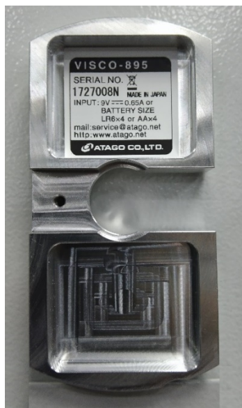
Рисунок 2 – Место нанесения серийного номера на вискозиметры ротационные ATAGO
