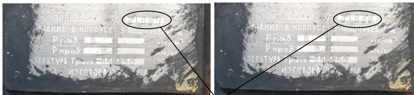
Места нанесения заводских номеров
