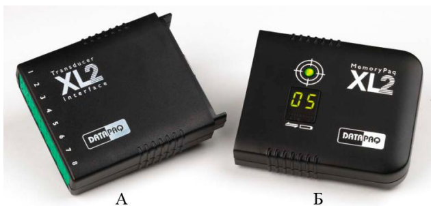
Рисунок 17 - Общий вид регистраторов серии XL2 (А - аналого-цифровой преобразователь модели TI0080A или TI0060A; Б - блок памяти модели MP0050A)
