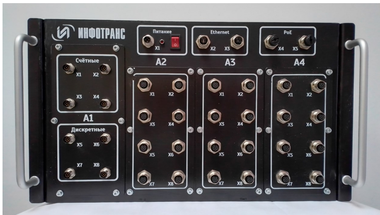
Рисунок 2 – Внешний вид измерительного контроллера ИВК ТЭЛ
