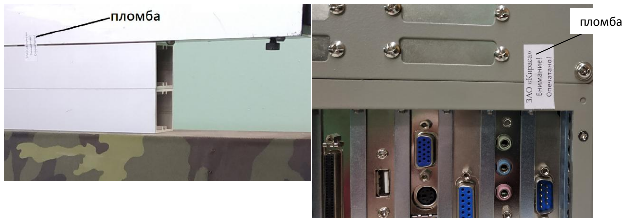
Рисунок 2 – Схема пломбировки комплекса измерительного баллистического «KIRASA PCI» от несанкционированного доступа
