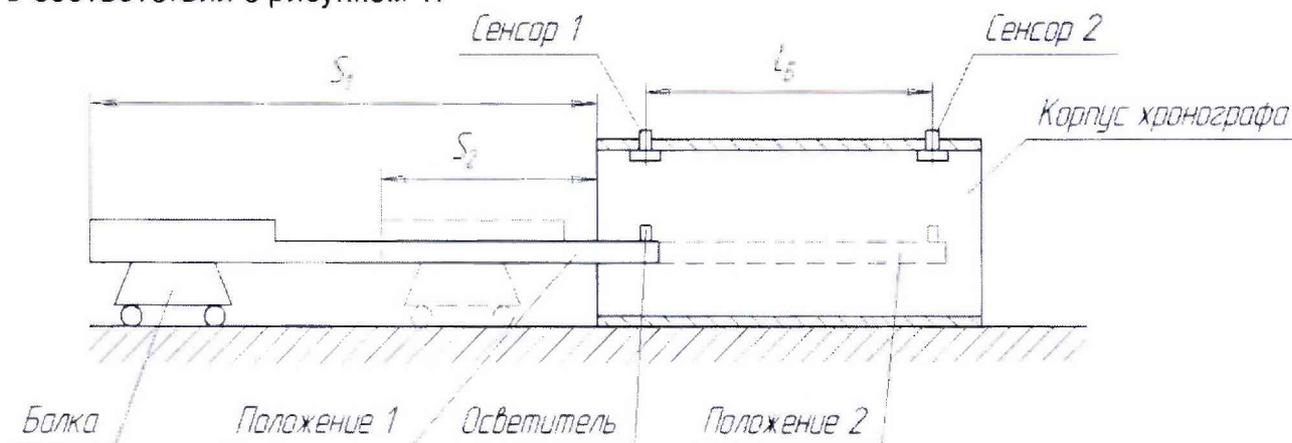
Рисунок 1 – Измерительная система для определения длины базы комплекса.
