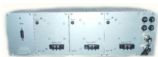
Рисунок 6 – Общий вид электронного блока ЦАП N для вывода пропорционального аналогового сигнала 100/\sqrt{3} В ДНЕЭ (вид сзади)
