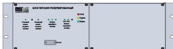
Рисунок 7 – Общий вид электронного блока резервированного блока питания повышенной надежности (вид спереди)
