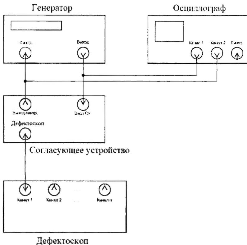
Рисунок 25 – Схема подключения для измерений времени отражения эхо-сигнала
