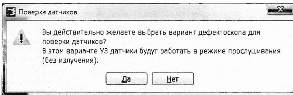
Рисунок 34 – Предупреждение об отключении зондирующего импульса.
