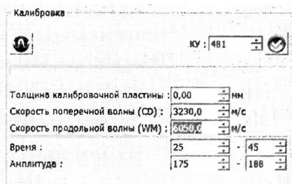
Рисунок 24 – Регулировка скорости распространения ультразвуковой волны в материале
