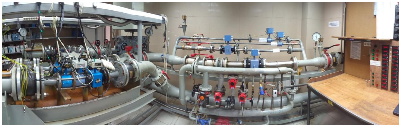
Рисунок 1 – Общий вид установки поверочной для расходомеров-счетчиков жидкости УПТ-200
