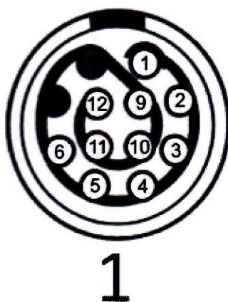
Рисунок 1 – Схема разъема ВТП на электронном блоке дефектоскопа
