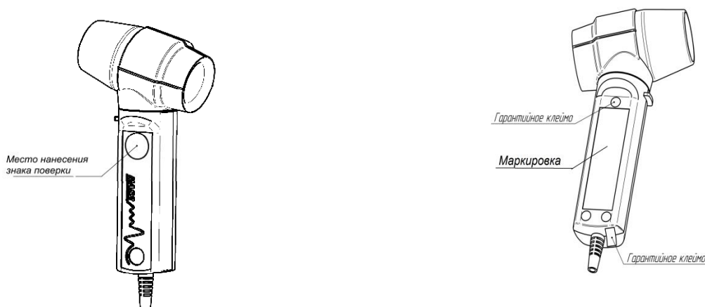
г) Схема пломбировки и маркировки спирометра MAC2-ПКм
