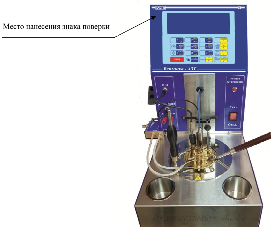
Рисунок 1 – Общий вид регистратора температуры вспышки нефтепродуктов в закрытом тигле автоматического «Вспышка – АЗТ»
