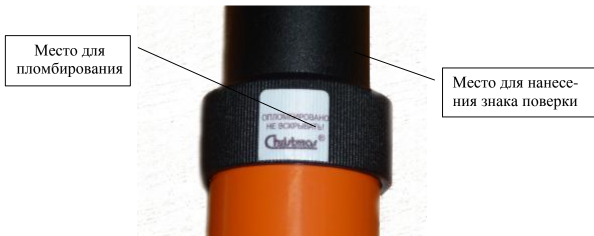
Рисунок 2 – Схема пломбировки и места нанесения знака поверки
