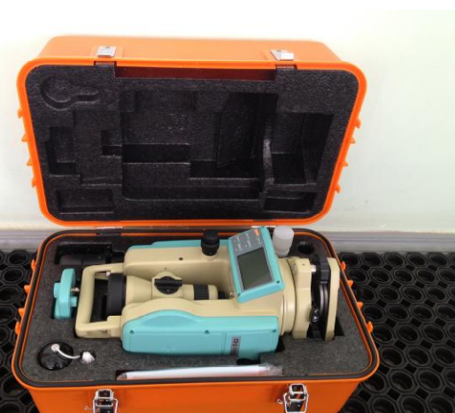
Рисунок 4 - Внешний вид теодолита при размещении в футляре
