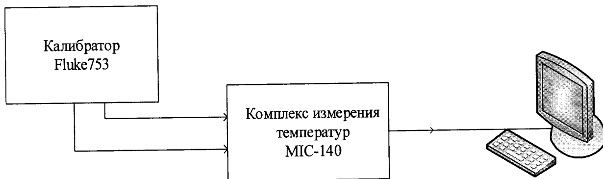
Рисунок 14 – Схема поверки ИК напряжения постоянного тока
