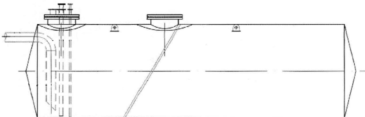
Рисунок 1 – Общий вид эскиза резервуара РГС-50
