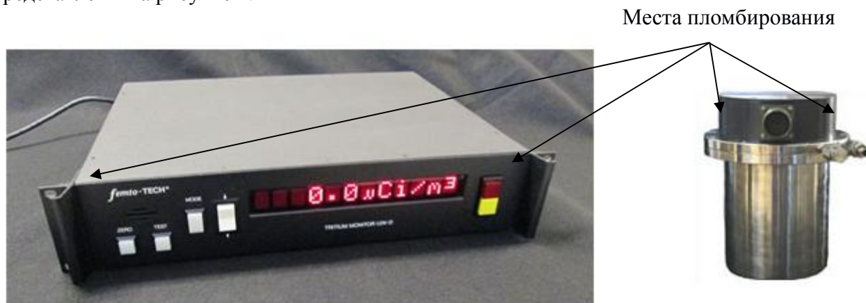
Рисунок 1 - Внешний вид составных частей радиометров: слева - блока управления и индикации, справа – ионизационная камера 224GB с электрометром
