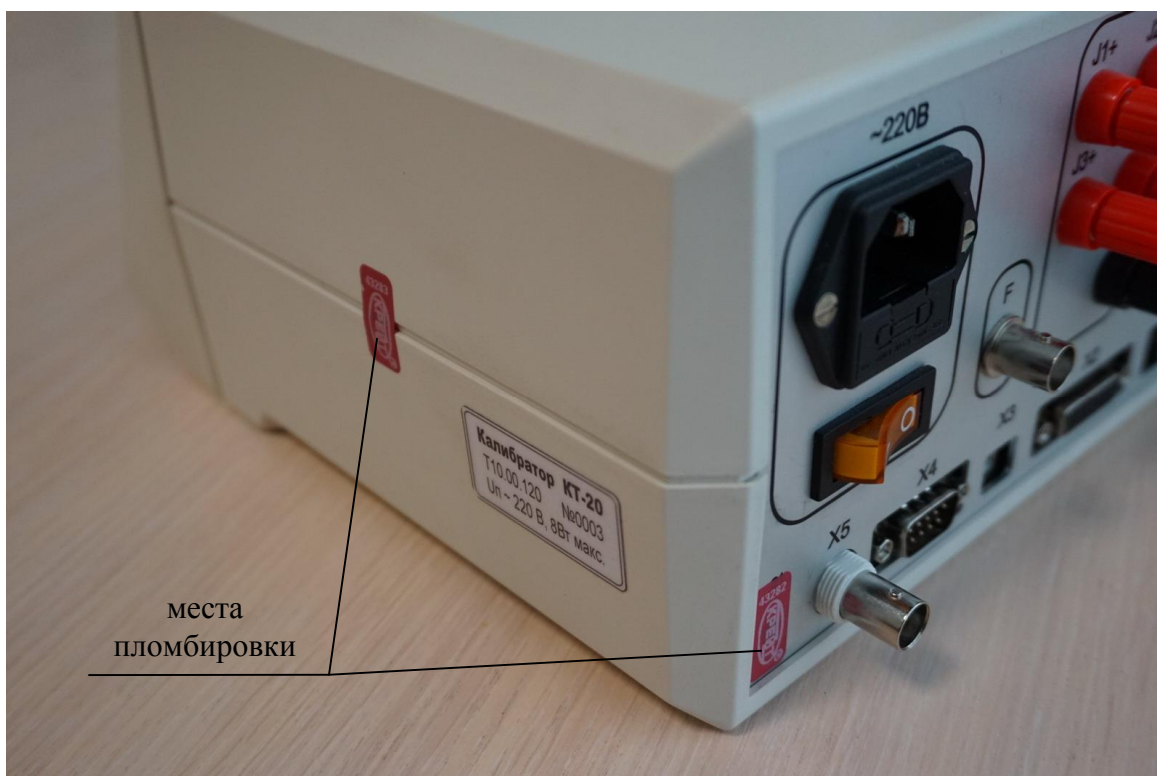
Рисунок 2 – Схема пломбировки от несанкционированного доступа
