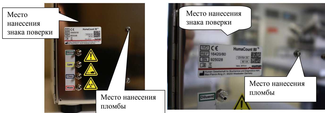
Рисунок 2 - Схема пломбировки от несанкционированного доступа, обозначение места нанесения знака поверки
