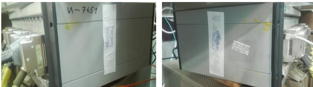
Рисунок 3 - Схема пломбировки от несанкционированного доступа MIC-036R
