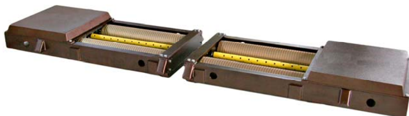
Рисунок 2 - Общий вид стандов тормозных СТН 3000М.02, СТН 13000.02
