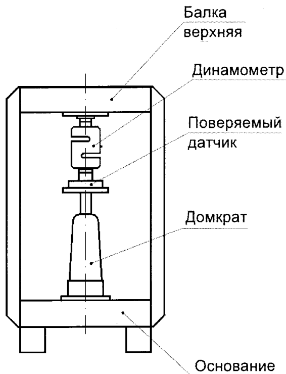
Рисунок 3. Схема поверки при определении относительной погрешности измерений усилий вталкивания сцепного устройства
