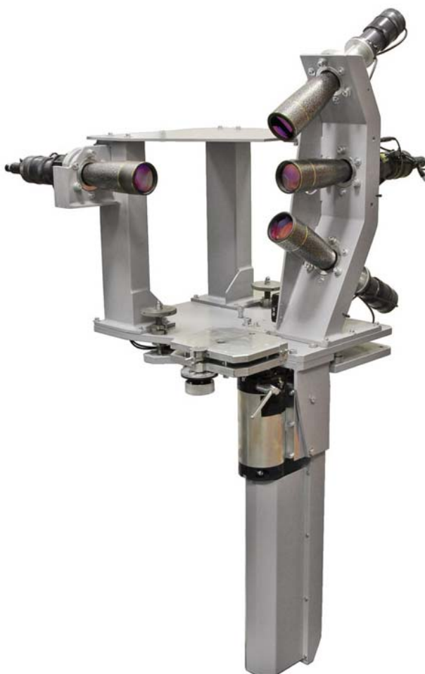
Рисунок 1 - Общий вид стенов универсальных коллиматорных ВЕГА УКС-М
