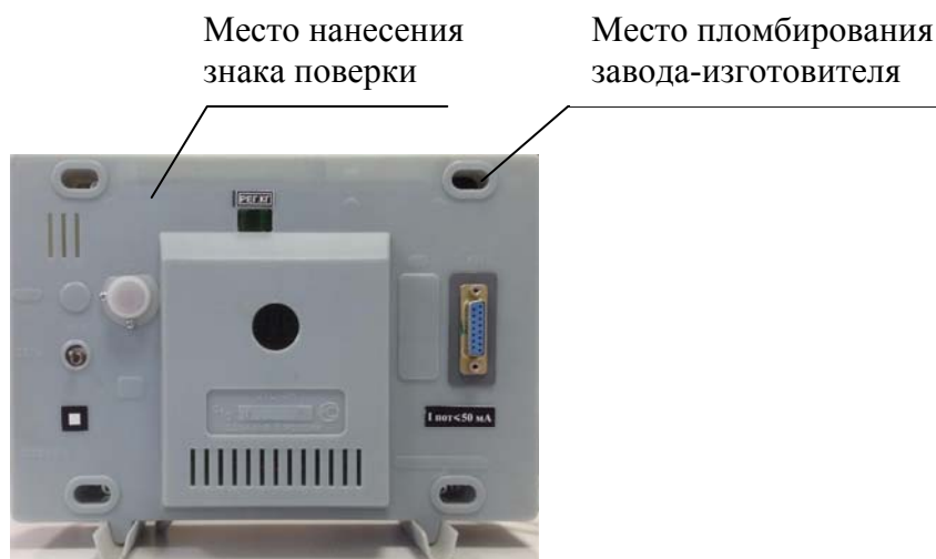
Рисунок 2 - Схема пломбировки от несанкционированного доступа
