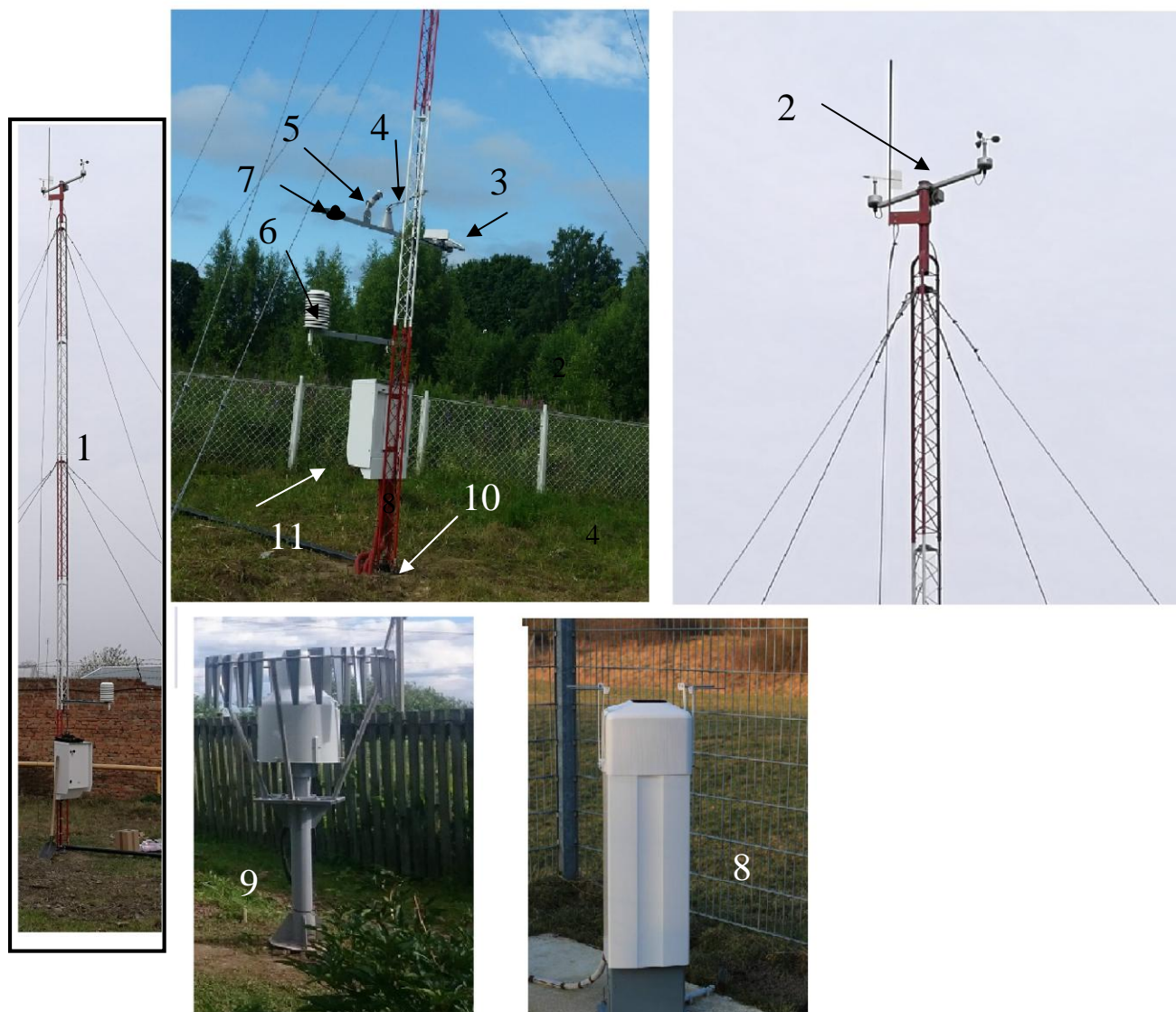
1 - общий вид комплекса «МКС-М5», 2 - ИК скорости и направления воздушного потока, 3 - ИК МОД, 4 - ИК высоты снежного покрова, 5 - ИК продолжительности солнечного сияния, 6 - ИК температуры и относительной влажности воздуха, 7 - пиранометр СМР6, 8 - ИК высоты облаков, 9 - ИК количества осадков, 10 - ИК температуры почвы, 11 - модуль центрального устройства.
